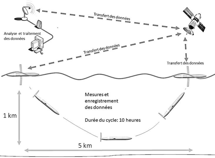
Cet engin sous-marin muni de capteurs, mesure en temps réel pour l'eau de mer :
